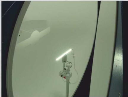
Измерение температурного режима работы светодиодов
